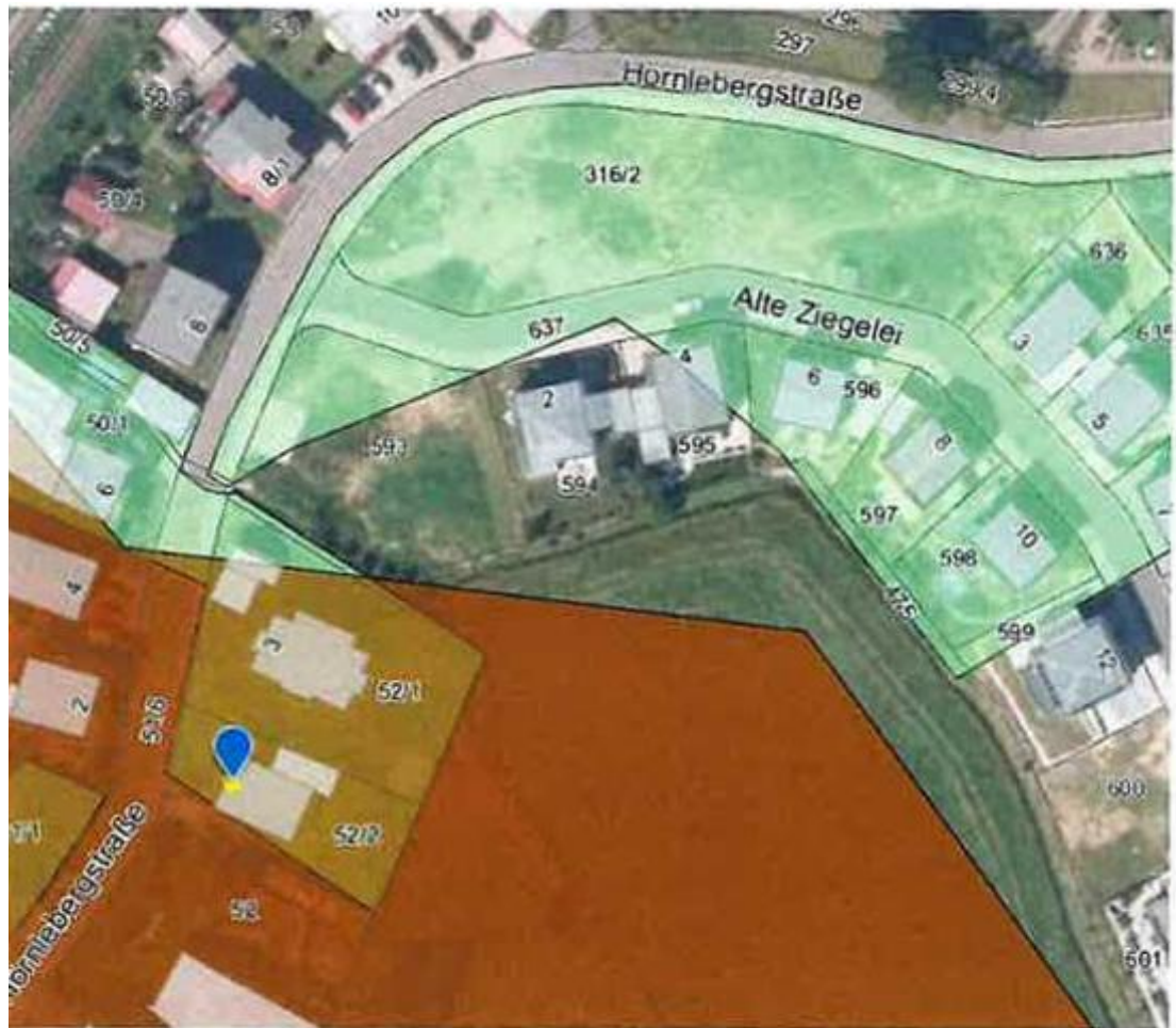
Zu Nr. 1 und 2) Das gesamte Bebauungsplangebiet befindet sich innerhalb der abgegrenzten schädlichen Bodenveränderung durch den historischen Bergbau. Es ist mit erhöhten Schadstoffgehalten des Bodens durch Arsen, Blei, Cadmium, Kupfer und Zink zu rechnen, die entsorgungsrelevant sind. Es ist im Ober- und Unterboden von Bleigehalten zwischen 100 und 250 mg/kg im Feststoff des Bodens auszugehen.
