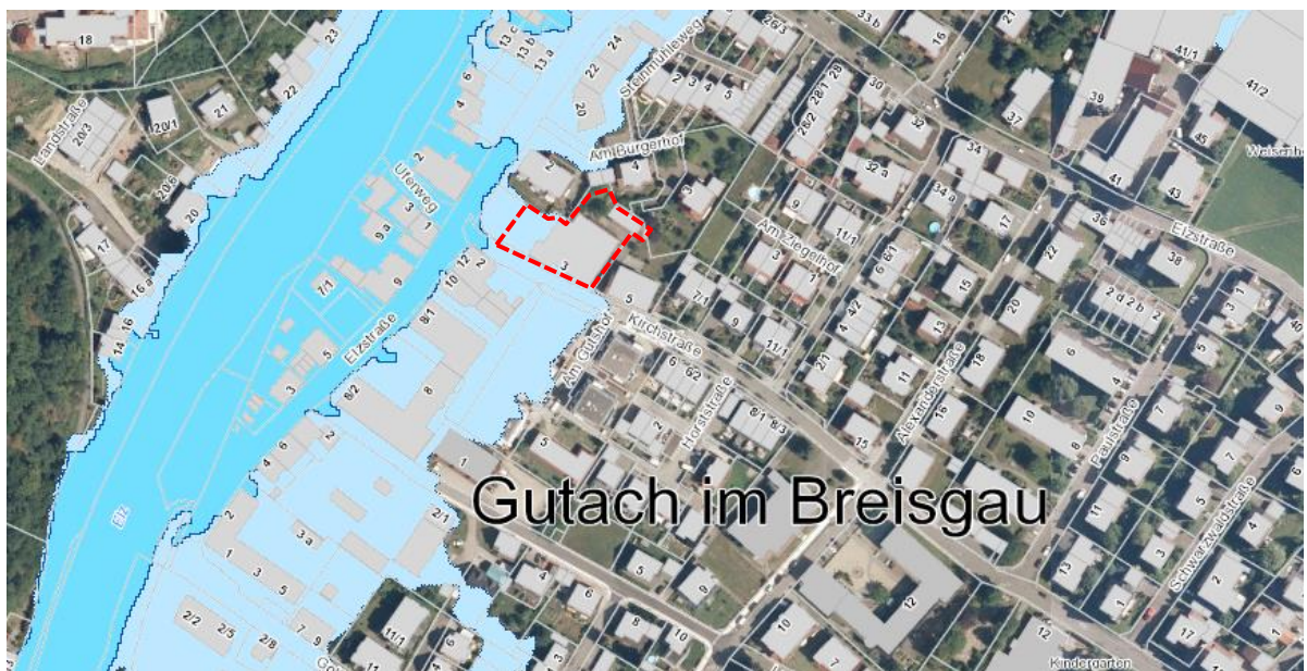
Darstellung des Überschwemmungsgebiets HQ100 (blau) und HQextrem (hellblau) mit ungefährender Abgrenzung des Plangebiets (rote gestrichelte Umrandung) – ohne Maßstab, Quelle: Geobasisdaten © Landesamt für Geoinformation und Landentwicklung Baden-Württemberg, www.lgl-bw.de, Stand 16.09.2020
